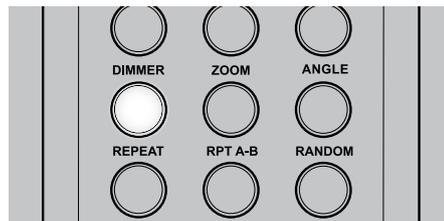
Verwenden Sie diese Funktion, um die Helligkeit des VFDs zu reduzieren oder wiederherzustellen.
