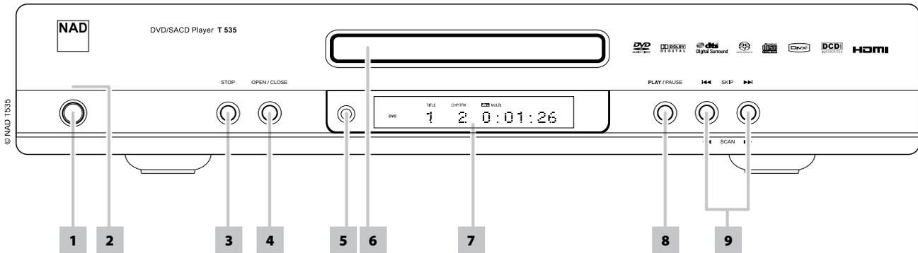
**1. Stromversorgung :** Drücken Sie diese Taste, um den T 535 einzuschalten. Die LED für die Bereitschaftsanzeige schaltet von gelb auf blau um und das VFD-Anzeigefeld leuchtet auf. Durch erneutes Drücken des Netzschalters wird das Gerät wieder in den Bereitschaftsmodus versetzt.
