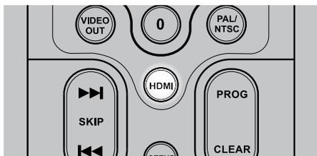
Der HDMI-Ausgang kann über die DVD 9 Fernbedienung mit der HDMI-Taste ein- oder ausgeschaltet werden. Im eingeschalteten Zustand wird auf dem VFD „HDMI ON“ und die entsprechende Auflösung angezeigt
