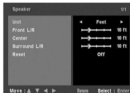
Im Menüpunkt [Einheit] ist die Entfernung einstellbar, in der der Abstand angezeigt werden soll [Fuss] oder [Meter].
