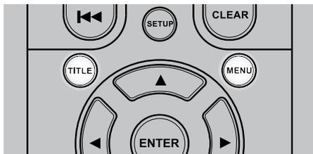
Diese beiden Tasten befinden sich lediglich auf der Fernbedienung. Sie werden verwendet, um die Titel und Menüs von DVDs und weiteren kompatiblen Disks auf dem Bildschirm anzuzeigen. Einige Filmdisks verfügen über zwei oder mehr Filmtitel. Wenn auf der Disk ein Titelmenü aufgezeichnet wurde, kann mithilfe der Taste TITLE ein Filmtitel ausgewählt werden. (Die Bedienung des Menüs ist abhängig von der verwendeten Disk.)
