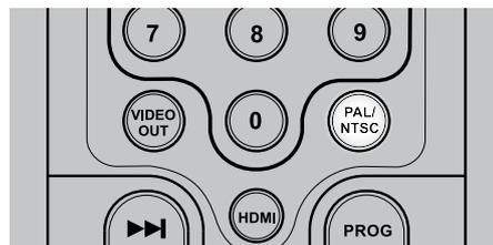
Betätigen Sie im STOP-Modus die Taste [PAL/NTSC] der DVD 9 Fernbedienung, um die TV-Farbnorm entweder auf PAL oder NTSC zu setzen. Die Tastenfunktion [PAL/NTSC] ist nur bei der Europa-Version der DVD 9 aktiviert.
